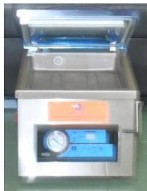
Gambar 4. Mesin pengemas vakum
